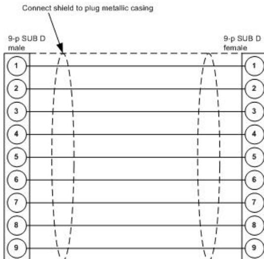
Wires min. 0.22 mm<sup>2</sup>, max. cable length 6 m.
