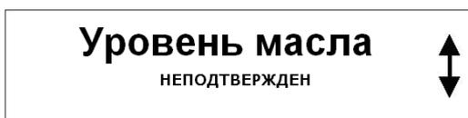
**Пример аварийного сообщения.** Список выводится на экран автоматически при появлении нового аварийного сигнала. Присутствие значка со стрелками означает, что имеется несколько активных аварийных сигналов. Для прокрутки списка следует нажимать . Чтобы выйти из режима отображения списка, следует нажимать кнопку **ESC**. Для подтверждения аварии необходимо выбрать сообщение и нажать кнопку .
