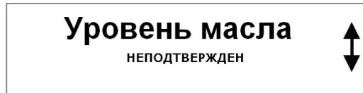
Контроллер при регистрации неисправности производит действия согласно заданному классу неисправности для данной аварии, при этом светодиод "Alarms" мигает красным цветом (это означает, что имеется хотя бы одна не квитированная/неподтвержденная оператором авария). Также при обнаружении неисправности может быть включена
