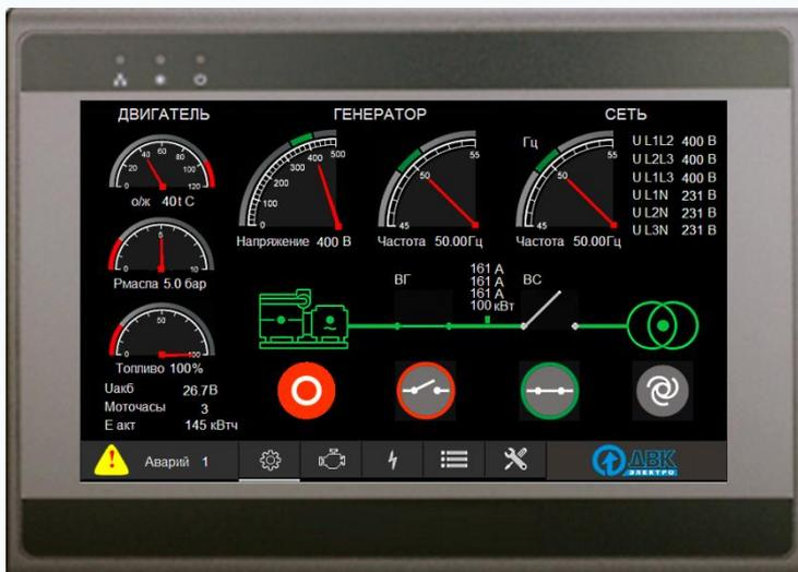
Панель подключается к контроллеру по интерфейсу Modbus RS485 и позволяет реализовать:
