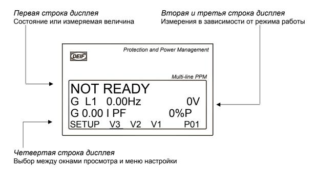
Меню просмотра предназначены для вывода на экран измеренных значений различных параметров.
