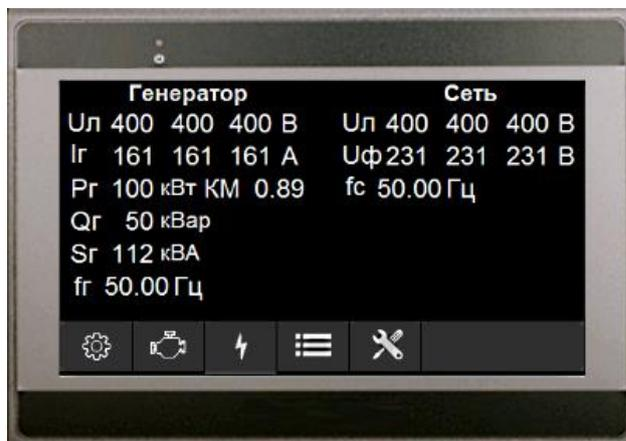
Рис.2 Параметры генератора
