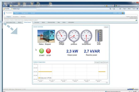
Мониторинг всех параметров генератора осуществляется на портале Netbiter Argos. Так же есть возможность выполнять пуск и останов генератора.
