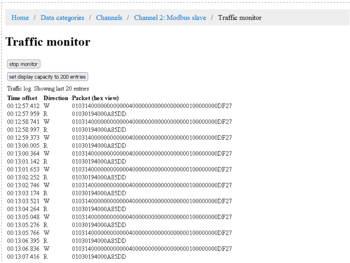
Скриншот окна сторонней утилиты, которая читает WB-C-DVK и создает трафик как на скриншоте выше:
