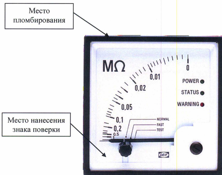
Рисунок 1 - Общий вид спереди измерителей сопротивления изоляции модификации SIM-Q с указанием места нанесения знака поверки
